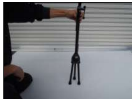
③ 支柱を引きだす
