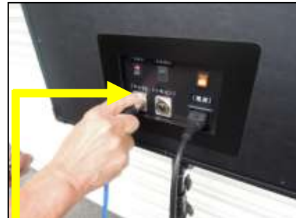
＜計測マイクケーブルを外す＞ 金具ピンを押しながらプラグを抜く
