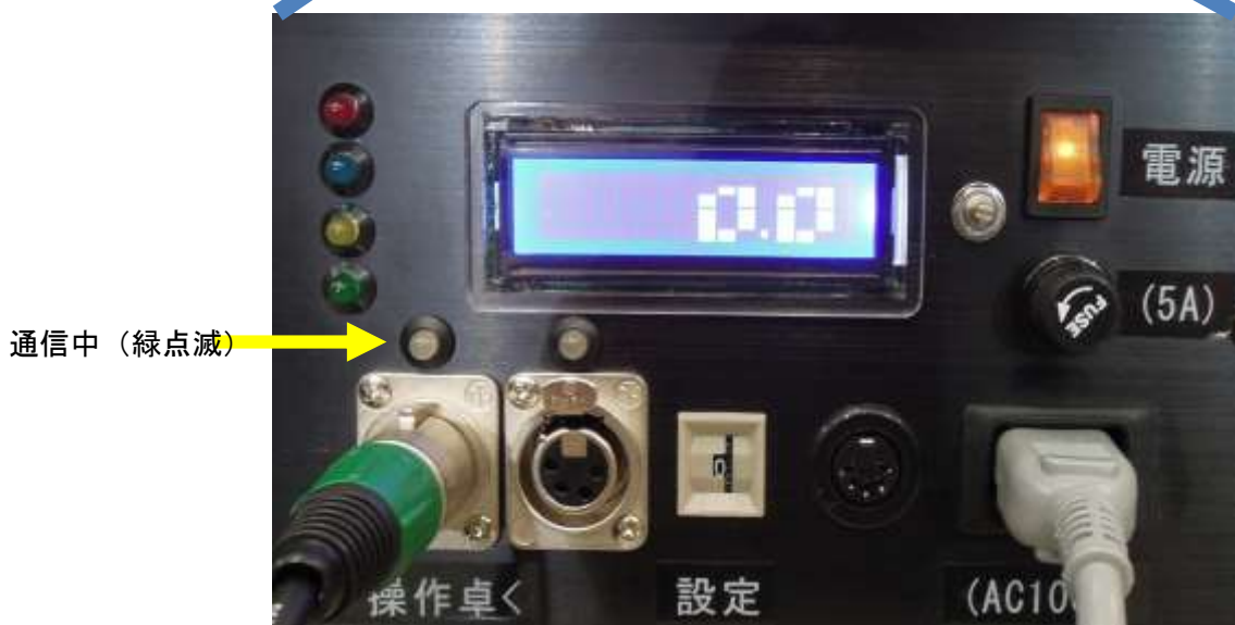
【表示機の接続パネル】
