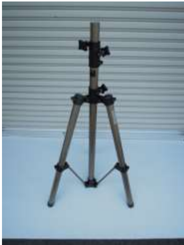
<広げた脚が狭いため不安定な状態>
