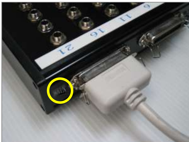
↑ 中継ボックスの2つあるコネクタの「MAIN」側へ接続 ↑ ロックピンでロックする
