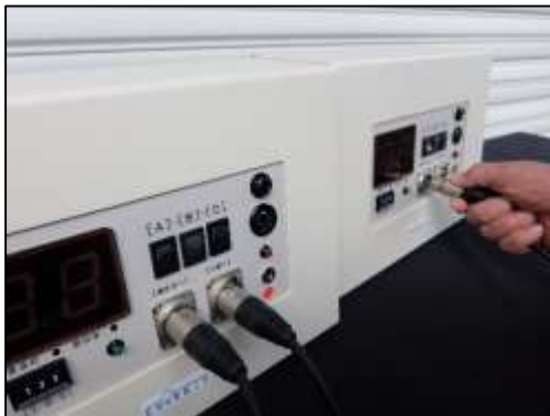
＜子機⇄子機間 通信ケーブルの接続＞
