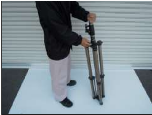
①右手部のネジをゆるめる
