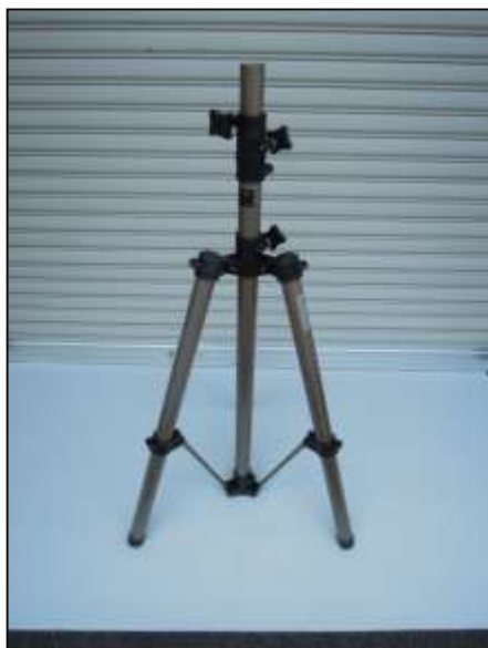
＜広げた脚が狭いため不安定な状態＞
